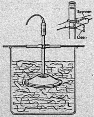
Der BOSCH-Schallwäscher wird am besten 15 bis 20 cm tief zwischen die Wäsche in den Kessel eingesetzt. Die Wäsche soll stets von Waschlauge bedeckt sein.
